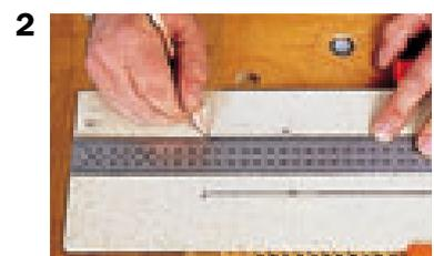
**L**e bandeau lumineux est une façon simple de créer un éclairage indirect efficace. Il est constitué d'une façade et de deux joues en contreplaqué ou en panneau de particules derrière lequel est fixée une régle fluorescente. Le bandeau est posé à la place d'une applique murale. On peut, au choix, fixer la régle sur le mur ou sur le bandeau.
